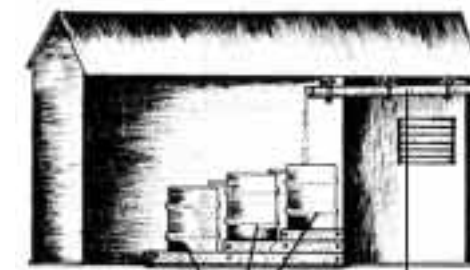
Fûts placés sur des supports Gouttière
