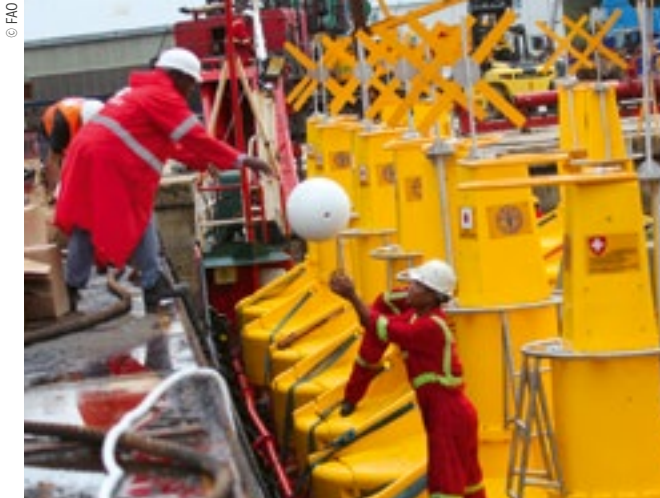
Les DCP se composent d'une grande bouée attachée à un "tapis" flottant de quelques mètres.
